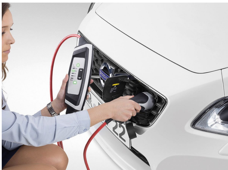
Bild 6: Ladekabel mit Steuer- und Schutzeinrichtung für ein Elektrofahrzeug bei Ladebetriebsart 2 (IC-CPD)
