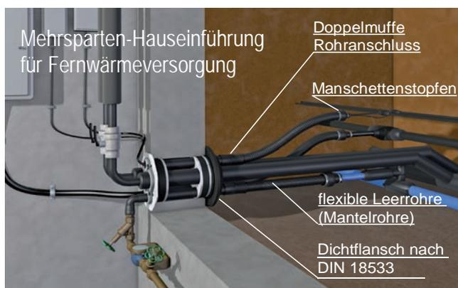
Bei Kellerwänden oder Bodenplatten aus wasserundurchlässigem Beton nach WU-Richtlinie empfiehlt sich der Einbau von Futterrohren.
